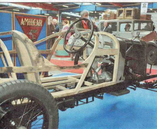
▲ La structure en bois de la carrosserie d'une Amlilcar CGS, en cours de restauration, est mise en évidence.
