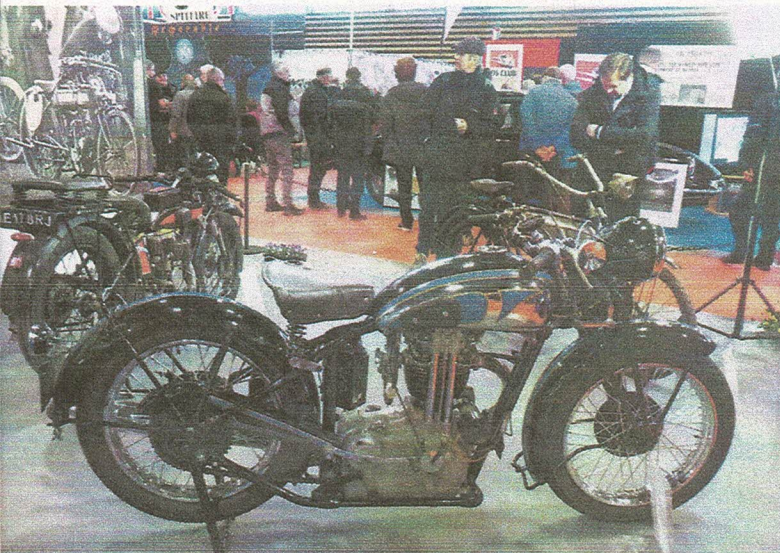
▲ Sur le stand de l'association des Belles Champenoises d'époque, on pouvait détailler cette FN (Fabrique Nationale belge) de 1938, modèle M 86 Super-sport, qui sortait 30 ch et atteignait le 130 km/h.
